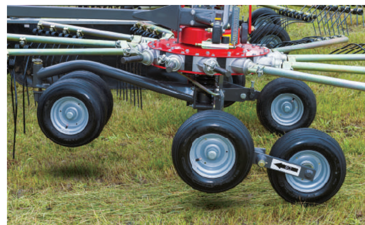
Patentované zavěšení rotoru pomocí kardanů.
